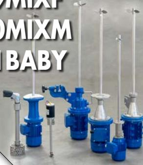
I miscelatori serie "MIX/F" con attacco a flangia, e serie "MIX/M" con attacco a morsetto, hanno motore elettrico e sono realizzati con lanterna in lega leggera. Tutte le parti a contatto con il fluido sono in acciaio inox AISI 316 (1.4401 - 1.4408). Tutte e due le versioni possono essere fornite con lanterna in acciaio inox AISI 316 (1.4408) e sono previste soluzioni a disegno su richiesta.
