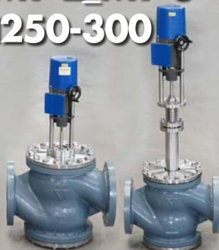
Valvole pneumatiche a due e tre vie di regolazione, DN 250 e DN 300, con corpo in ghisa sferoidale (EN-GJS-400-18LT), corpo AISI316 (1.4408), acciaio al carbonio LCB A352 (1.6220), superduplex F55, azionate da servoco, arnido a membrana tipo: N109(Ø520), N216(Ø520 doppio). Le tre vie possono essere eseguite sia deviatrici che miscelatrici. Per ulteriori informazioni consultare il catalogo 11M9-2\_11M9-3 DN250-300.
