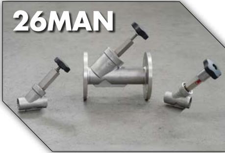
**Valvole manuali con corpo a flusso libero o a squadra, disponibili dal DN 15 al DN 300, con attacchi filettati BSPP femmina, a saldare di tasca, filettati NPT, flangiati foratura PN25 UNI EN 1092-1, flangiati ridotti. Corpo in acciaio inox AISI 316 (1.4408) ottenuto da microfusione, temperatura massima di utilizzo 195°C. Per ulteriori informazioni consultare il catalogo 26MAN.**
