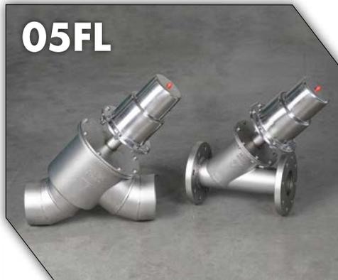
**Valvole pneumatiche a due vie di intercettazione tipo on-off a flusso libero (45°), disponibili nei funzionamenti normalmente chiuso, normalmente aperto o a doppio effetto, dal DN 80 al DN 150, con attacchi a saldare di testa, flangiati con foratura PN16 UNI EN 1092-1, flangiati ridotti. Corpo in acciaio inox AISI 316 (1.4408) e servocomando in acciaio inox AISI 304 (1.4301), temperatura massima di impiego 150°C. Per ulteriori informazioni consultare il catalogo 05FL.**
