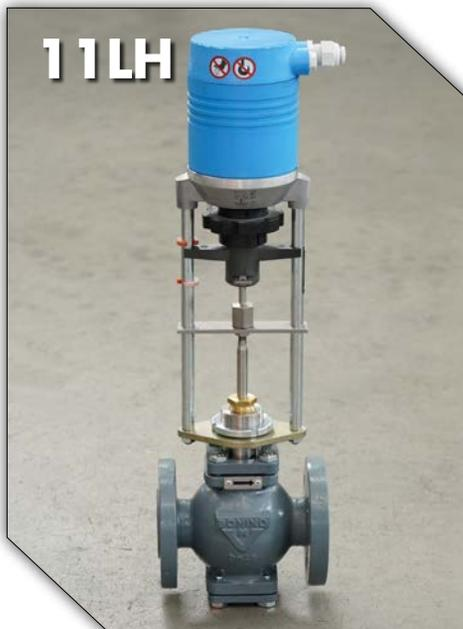
Attuatore elettrico tipo "LP" a movimento lineare, segnali di input e output reversibili indipendentemente; segnale di input regolabile liberamente: 3 punti o modulante; grado di protezione IP54. Per ulteriori informazioni consultare il catalogo 11 LH.
