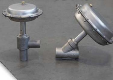
Valvole con corpo in acciaio inox AISI 316 (1.4408), aventi un servocomando modulante, disponibili dal DN 15 al DN 65 nei vari segnali di comando: 3÷15, 6÷18, 6÷30 psi. Possono operare ad una temperatura massima di +195°C e sono fornibili con una svariata serie di connessioni. Sono caratterizzate da ingombri ridotti che ne permettono l'installazione anche dove vi sono problemi di spazio.
