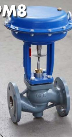
Valvole pneumatiche a due vie di regolazione serie "M8" con corpo in ghisa sferoidale EN-GJS-500-7, temperatura di utilizzo: -10°C +210°C, o in acciaio al carbonio LCB A352 (1.6220), temperatura di utilizzo: -15°C +210°C, disponibili dal DN 15 al DN 100, azionate da servocomando a membrana tipo: SS0 (Ø200), SS1 (Ø 275), SS3 (Ø360), SS2 (Ø430) SS6 (2xØ275), SS5 (2xØ360), SS4 (2XØ430).
