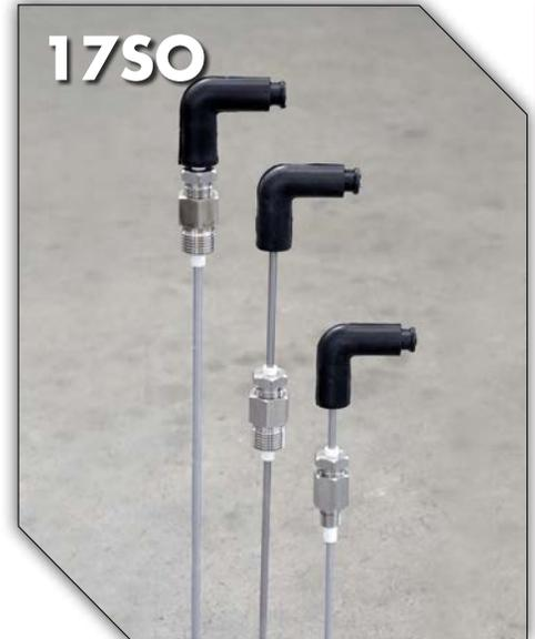
Sonde di livello conducimetriche in acciaio inox AISI 316 (1.4401), con attacchi standard da 1/2" BSPP (filettati maschio), guaine in PTFE (temperatura massima di utilizzo 160°C).
