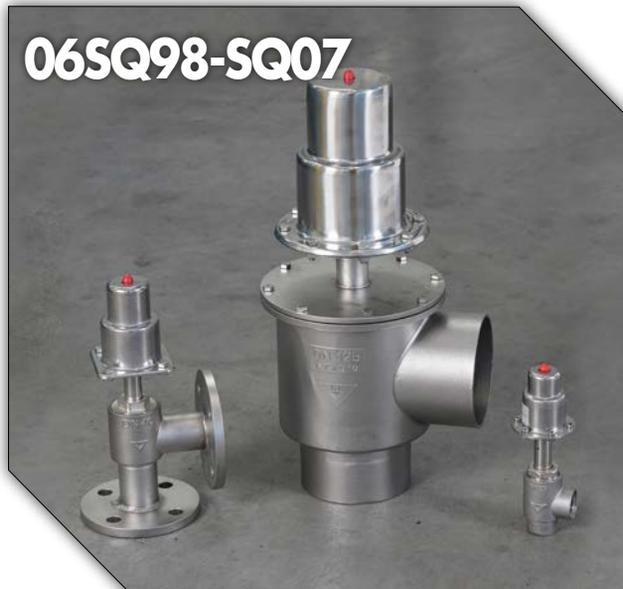
**Valvole pneumatiche di intercettazione on-off a squadra, disponibili nei funzionamenti normalmente chiuso, normalmente aperto o a doppio effetto, con servocomando in acciaio inox AISI 304 (1.4301).**
