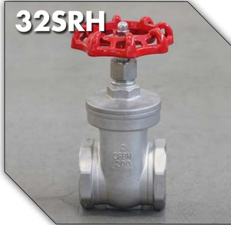
**Valvole a saracinesca con corpo in acciaio inox AISI316 (1.4408) disponibili dal DN15 al DN65, con attacchi filettati BSPP, o a richiesta flangiati foratura PN25 UNI EN 1092-1 o flangiati ridotti. Disponibili con azionamento manuale o attuatore pneumatico. Per ulteriori informazioni rivolgersi al nostro ufficio tecnico/commerciale.**
