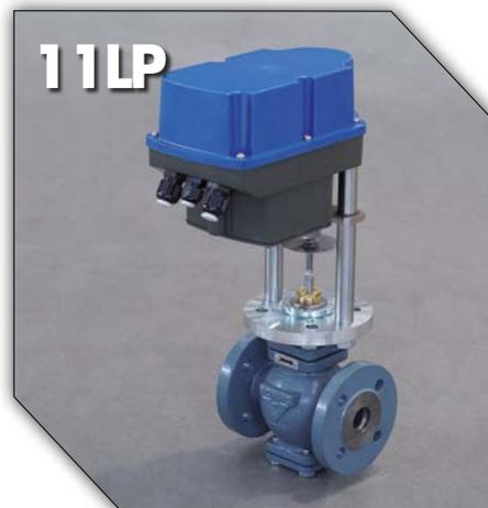
Attuatore elettrico tipo "LP" a movimento lineare, alimentazione 24...230VAC/VDC; segnale di input 3-punti o modulante, grado di protezione IP65. Funzione fail-safe. Custodia in alluminio-polycarbonato. Per ulteriori informazioni rivolgersi al nostro ufficio tecnico/commerciale.
